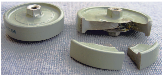
Рис. 7. Высоковольтный конденсатор после пробоя
