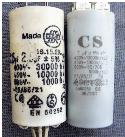
Рис. 8. Конденсаторы, на которых указан срок службы при разных напряжениях
