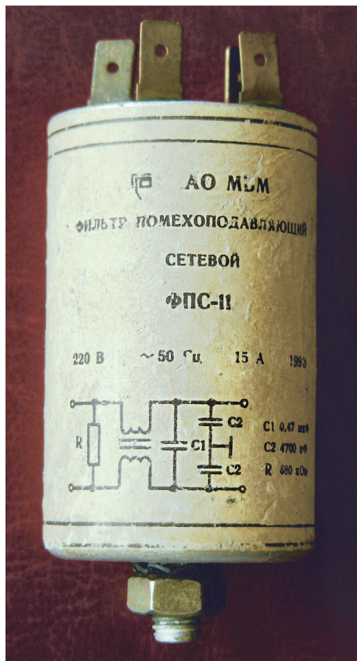
Рис. 6. Фильтр с изображенной на нем схемой
