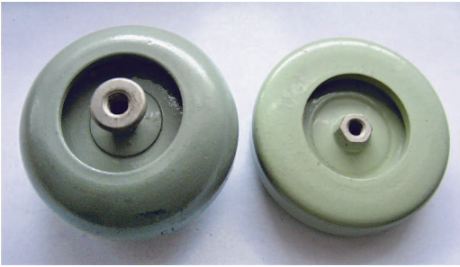
Рис. 3. Керамические конденсаторы. Весь объем занят керамикой, а электроды — маленькие диски, один под гайкой (где выпуклость на краске)
